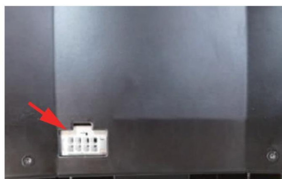
10. Zapojte druhý konec kabelu do zdířky na zadní straně kávovaru.
