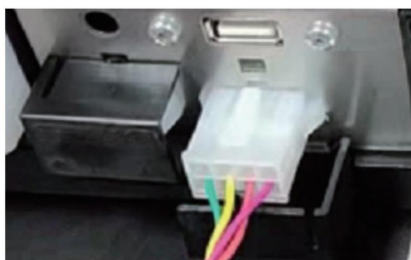
9. Zapojte kabel pro připojení ke kávovaru do zdířky na zadní straně sirupové stanice
