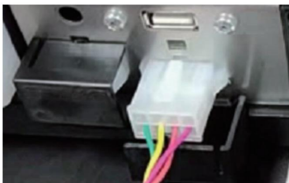
9. Zapojte kabel pro připojení ke kávovaru do zdíčky na zadní straně sirupové stanice
