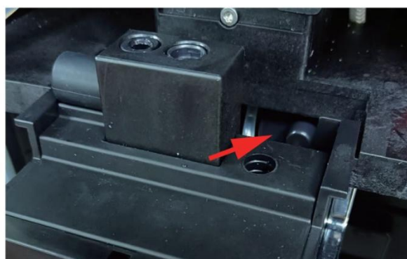
8. Umístěte sirupové hadičky do výdejní pozice a poté zapojte napěňovač mléka zpět do kávovaru.
