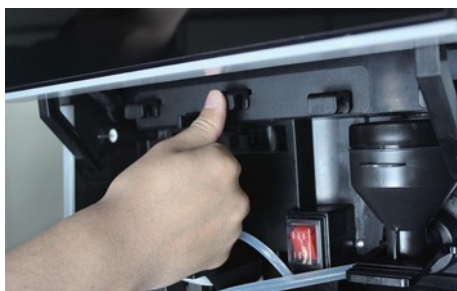
7. Zatlačte zajišťovací jezdec úplně dovnitř
